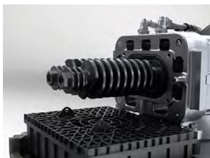
Figuur 2. Lagering van de spindels met ophanging aan één uiteinde.
