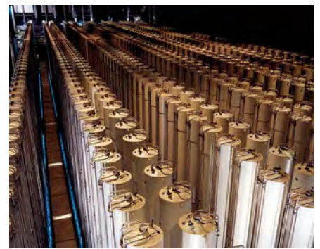
Een cascade van centrifuges die draaien in een vacuümomgeving.
