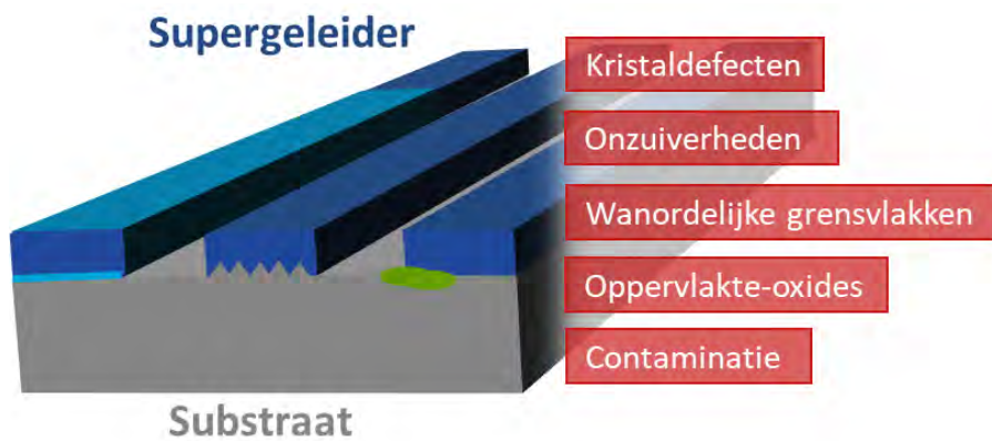
Figuur 3. Een bewerkte supergeleidende laag met mogelijke bronnen van ruis die de functionaliteit van de laag negatief beïnvloeden.
