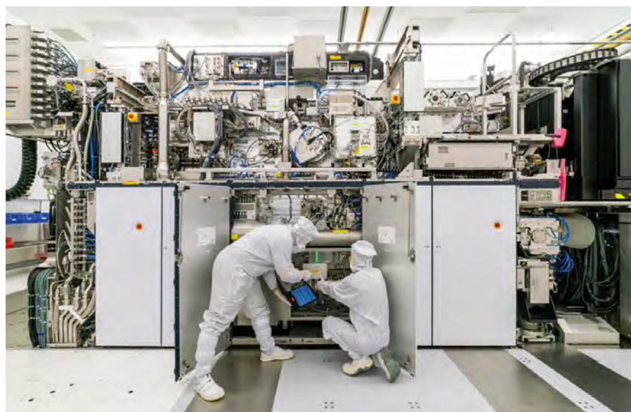
Figuur 1. Een lithografiemachine kan uit meer dan 100.000 onderdelen bestaan. (Bron: ASML)
